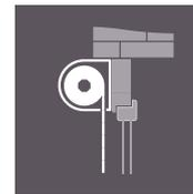
Wahlweise vor Fenstern mit Blendrahmenverbreiterung oder an der Fassade montierbar
